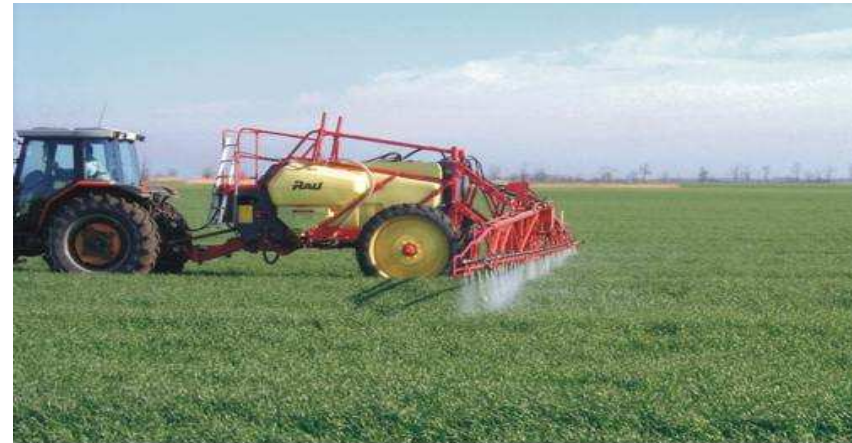
Vontatott kivitelű szántóföldi permetezőgép munka közben (Agroszöv Rt., Jászkisér)
